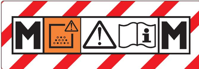
**KLASSE M - Aufkleber an der Maschine für die Eignung zum Aufsaugen von gefährlichem Staub mittleren Risikos zur Trennung von Staub mit Expositionsgrenze, je nach belegtem Volumen  $\geq 0,1 \text{ mg/m}^3$ .**
