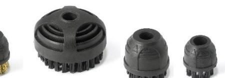
Ces brosses doivent être utilisées attachées à l'accessoire BAGUETTE À VAPEUR. Utilisé pour éliminer la saleté tenace et nettoyer en profondeur, même dans les coins ou les petits espaces. Choisissez le type de poils : nylon, laiton, acier en fonction de la surface à traiter. Disponible en 3 tailles : diamètre 28 mm, 40 mm, 60 mm
