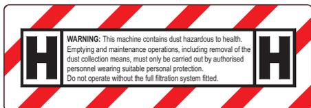
**Klasse H** - Aufkleber auf einer Maschine, die zum Absaugen gefährlicher Stäube mit hohem Risiko geeignet ist, um den Staub mit einem Expositionsgrenzwert in Abhängigkeit vom belegten Volumen abzutrennen  $< 0,1 \text{ mg/m}^3$ .
