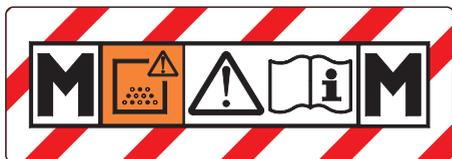
**Klasse M** - Aufkleber auf einer Maschine, die zum Absaugen gefährlicher Stäube mit mittlerem Risiko geeignet ist, um den Staub mit einem Expositionsgrenzwert in Abhängigkeit vom belegten Volumen abzutrennen  $\geq 0,1 \text{ mg/m}^3$ .
