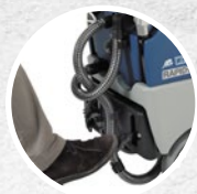
Anhebesystem des Saugbalkens mit Pedal
