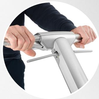
Palancas de seguridad para detener todas las funciones de la máquina si el operador las suelta. Máxima seguridad incluso en caso de paradas bruscas.
