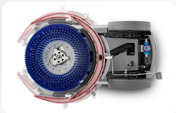
Keine Einstellungen: Der Saugbalken ist bereits für die gängigsten Reinigungsaufgaben eingestellt und hat einen Drehbereich von bis zu 170° (85° pro Seite). Der bürstenlose 150-Watt-Vakuummotor ermöglicht eine hohe Leistung bei geringem Energieverbrauch. Die standardmäßig mitgelieferten Sauglippen Para können auf allen vier Seiten verwendet werden und sind unübertroffen in der Unterhaltsreinigung und auf Böden mit anspruchsvollen Verschmutzungen.
