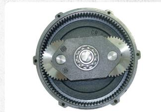
RIDUTTORE A SATELLITI E PLANETARIO
