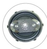
Riduttore a satelliti e planetario (M22)
