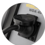
Conexión herramientas eléctricas
